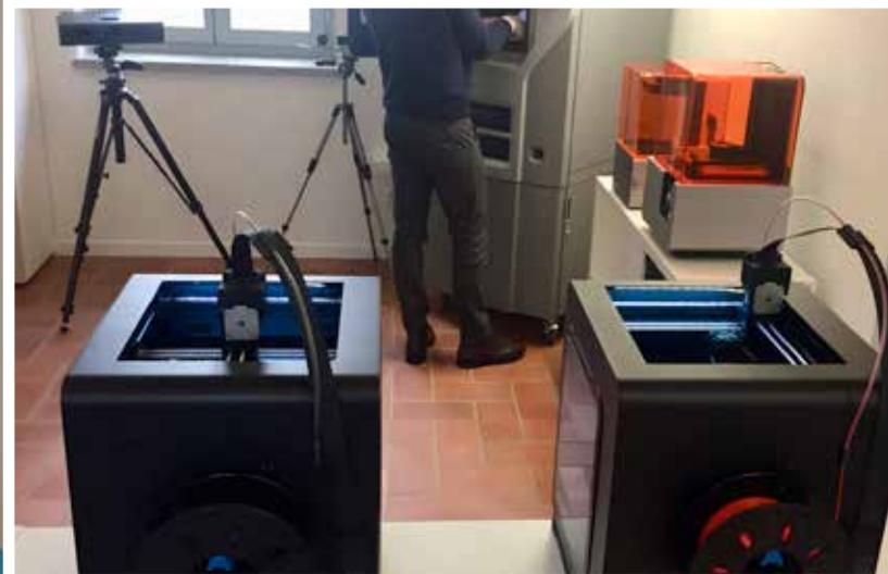
bina di filo che tramite un estrusore riscaldato deposita il materiale su un piatto di stampa per creare i vari layer. La tecnologia Sla si basa invece su una vaschetta di resina e un laser, il quale va ad agire sul materiale liquido con l'effetto di indurirlo. I pezzi crescono a contatto con il vasoio di stampa dall'alto verso il basso e hanno caratteristiche estetiche davvero elevate.
